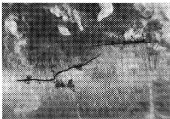
图3 应力腐蚀开裂裂纹的形状
